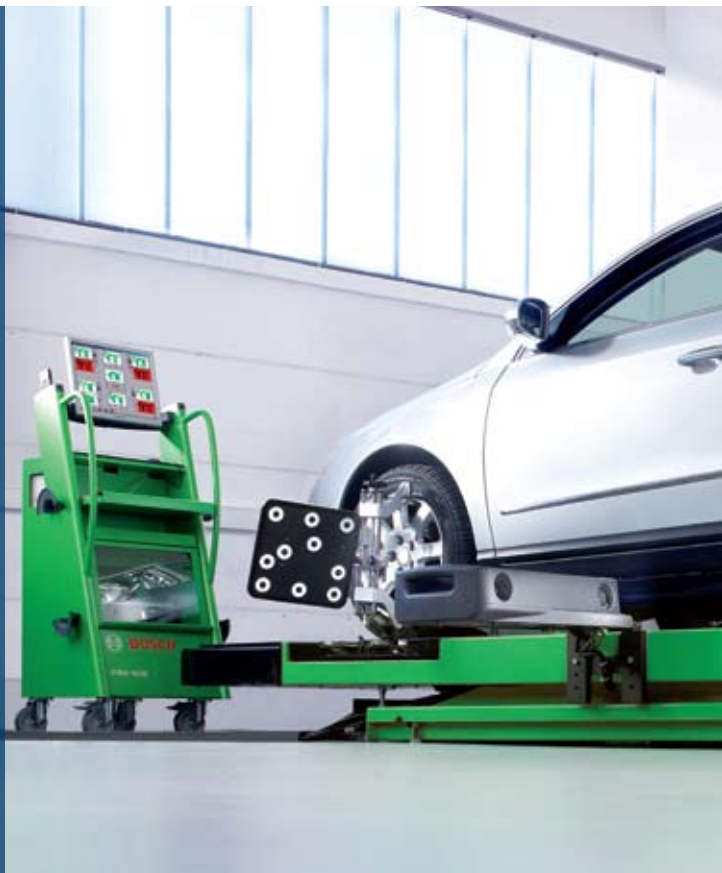
Enkel betjening: Bilen skal ikke løftes op under målingen
