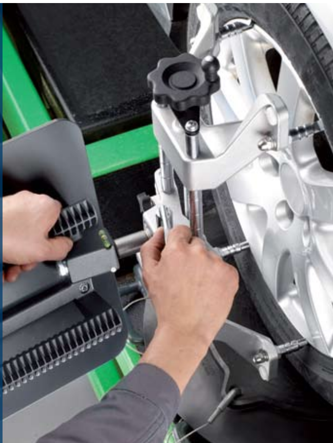
Enkel montering – indstilling af måletavlerne er kun nødvendig én gang
